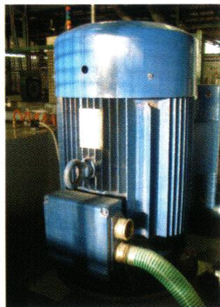
Moteur 90Kw centrale hydraulique - MFR 4000
